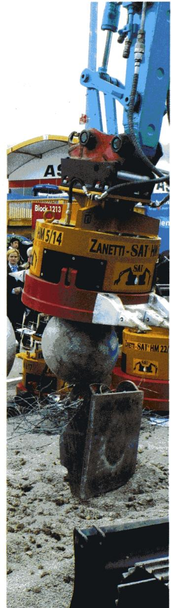
Elektromagnet von SAT Schwiebacher
